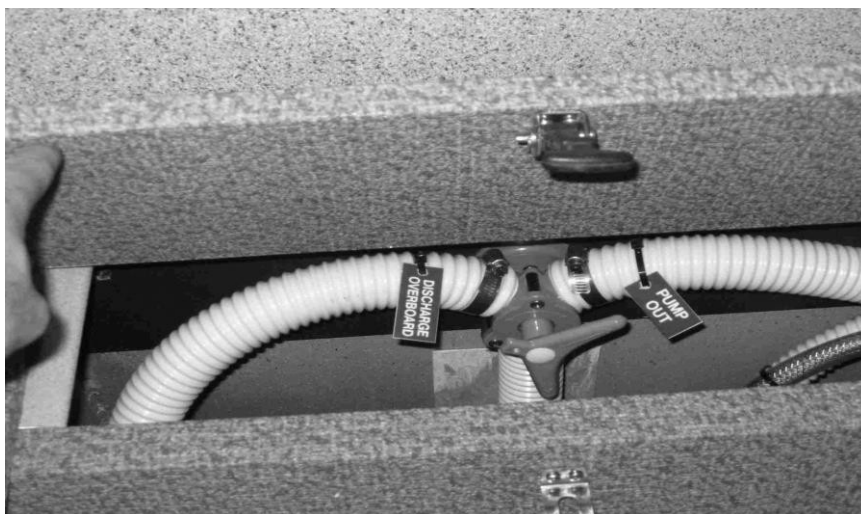
Emplacement de la vanne en Y 28' / 30'
